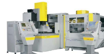
OPS-INGERSOLL G8000 OPS600 Электро-эрозионный станок с ЧПУ центром для изготовления электродов
