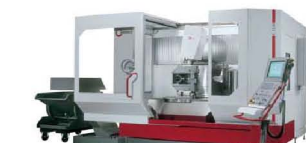
Hermle U1130 Фрезерный центр точностью обработки 0.01 мм
