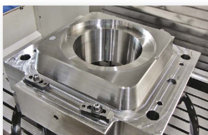
Матрица ведра 11 л. во время фрезерной обработки
